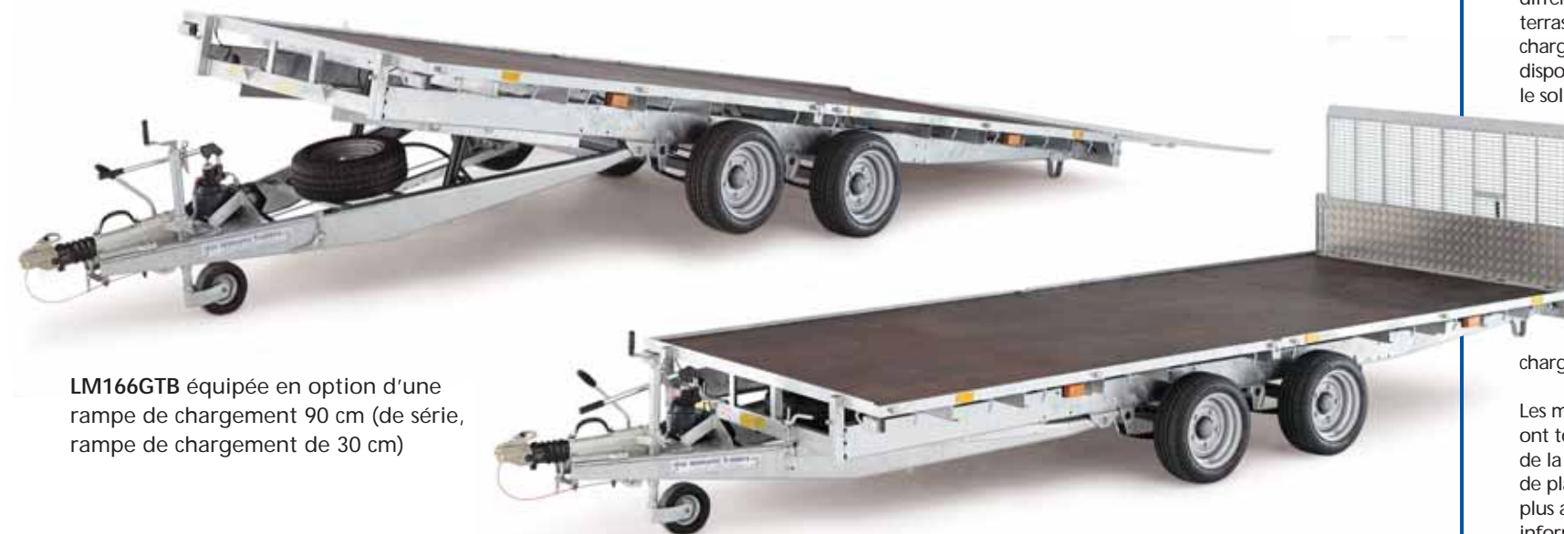
LM166GTB équipée en option de ridelles latérales et avant et d'une rampe de chargement 90 cm
