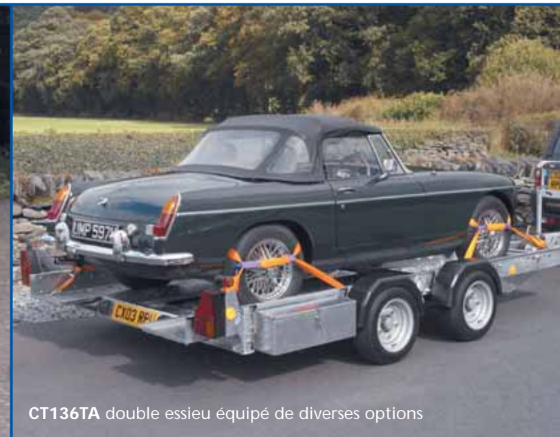
CT136TA double essieu avec cales de roues et roue de secours
